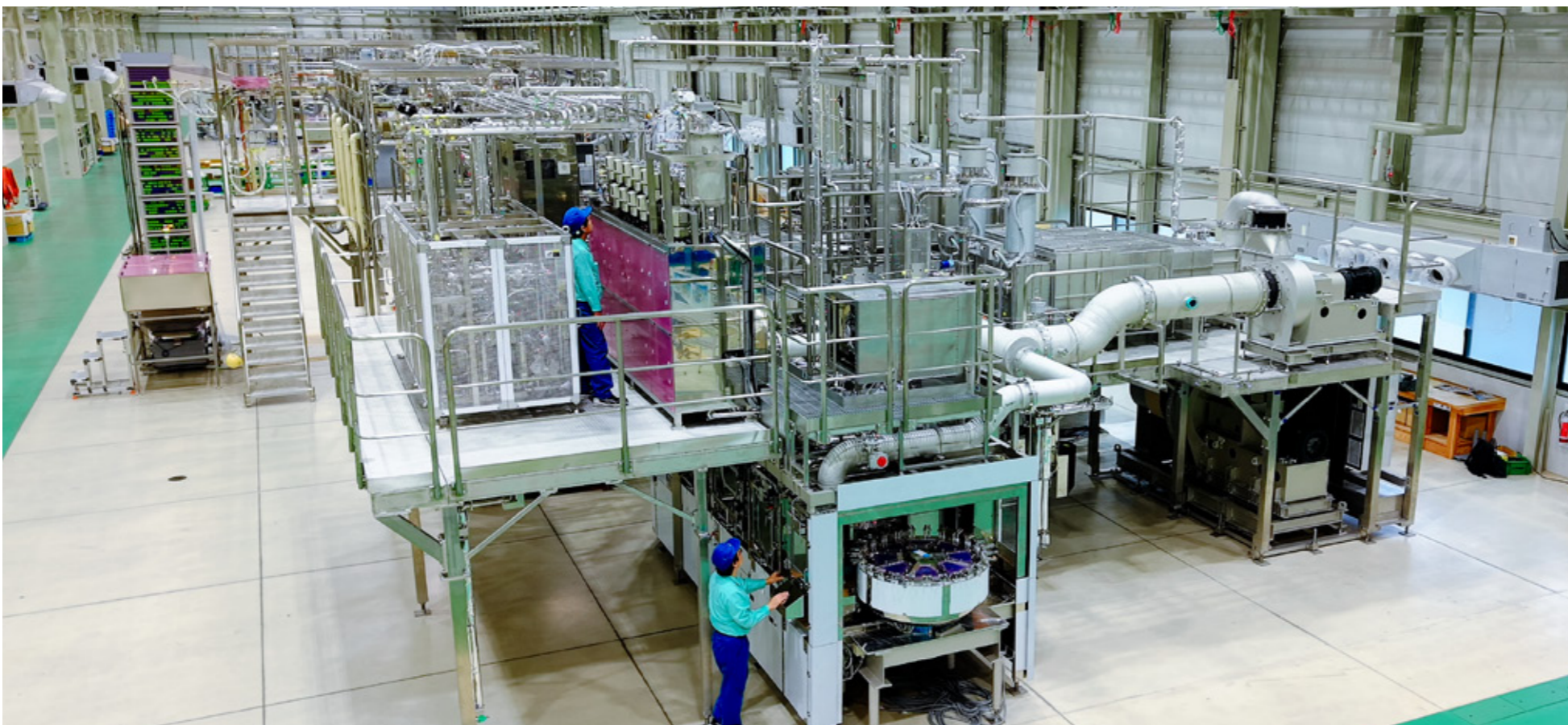
新製品「新型2段階菌充填システム」の製造風景。ボトル殺菌に要する薬剤使用料の大幅な削減が可能となった。
